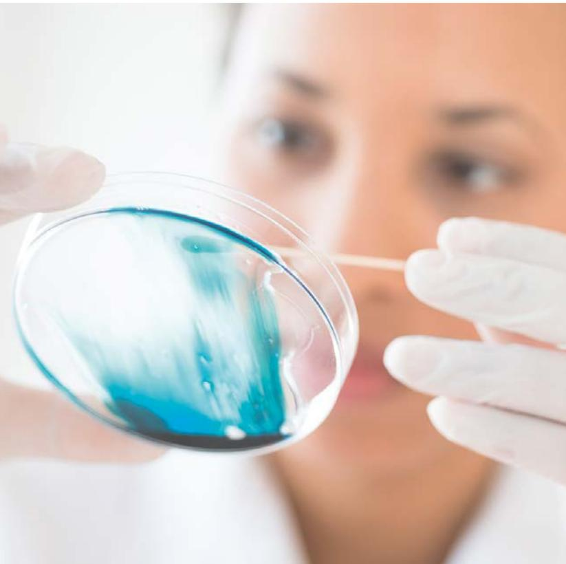
Bestimmung der Resistenz gegen verschiedene Pilz-, Bakterien- und Hefestämme nach ASTM G21/G22.
