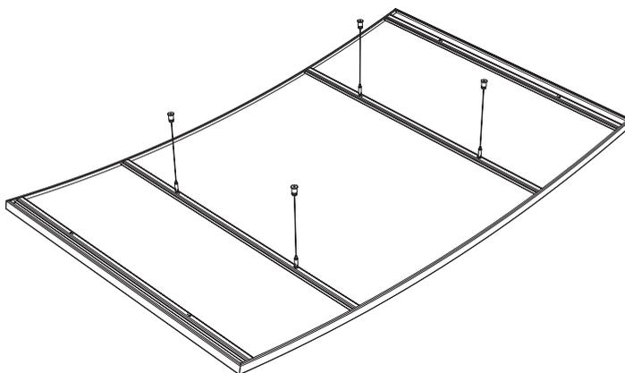
Alle Deckensegel werden fertig montiert in einem Stück geliefert. Das garantiert eine einfache und schnelle Montage. Die flexible Abhängung mit Stahlseilen ermöglicht eine individuelle Höhenverstellung ganz nach Wunsch.
